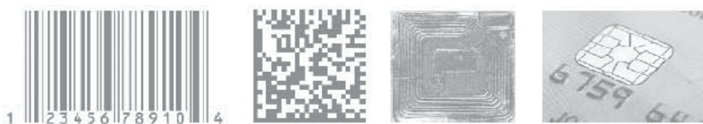
Figura 2. Código de barras, código de barras bidimensional, IDRF y chip
